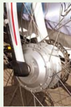
Motor v předním náboji je od značky Tranz-X, která dodává své systémy mnoha výrobčům kol. V tomto případě je motor vybaven brzdovým kotoučem.
