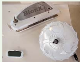
Komplet elektropohonu od BionX obsahuje motor s rekuperací energie v zadním náboji, tvarově uzpůsobenou baterii do rámu a ovládací jednotku na řídítka. BionX je jedním z největších dodavatelů systémů pro elektrokola.
