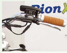
Na detailu brzdové páky je vidět spleť kabelů, které z ní vycházejí. Sensor má na starosti vypnutí systému pohonu, jakmile se začne brzdit, případně aktivuje rekuperaci energie.
